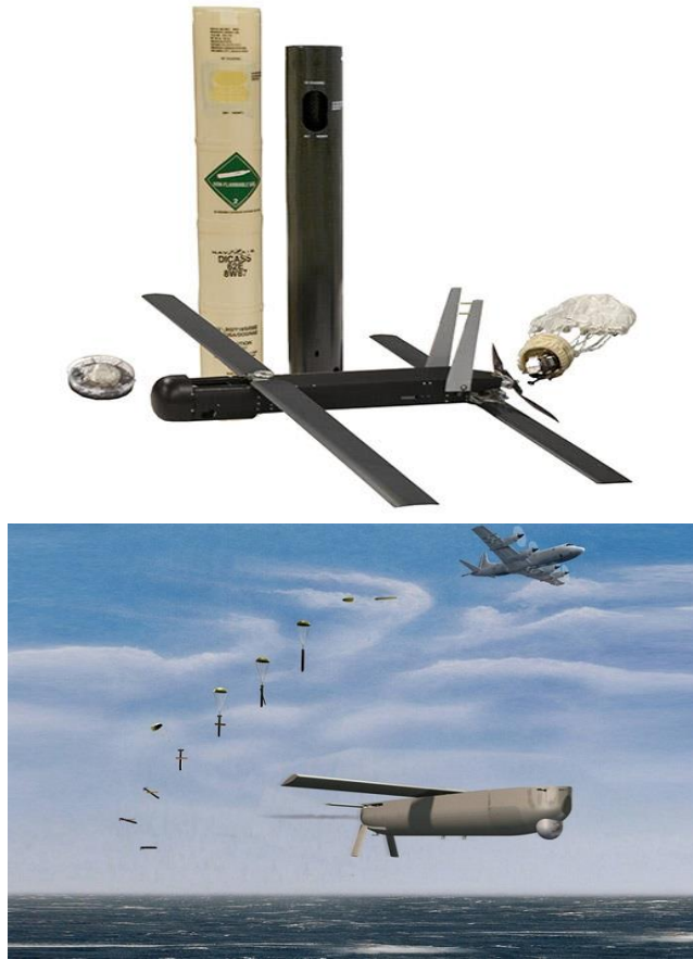
Figur 15: Øverst: Coyote Mini-UAV og sonarbøye-containeren den pakkes i. Nederst: Animasjon av deployering av en Coyote (fra en P3) (kilde: http://www.navaldrone.com/Turais.html )
