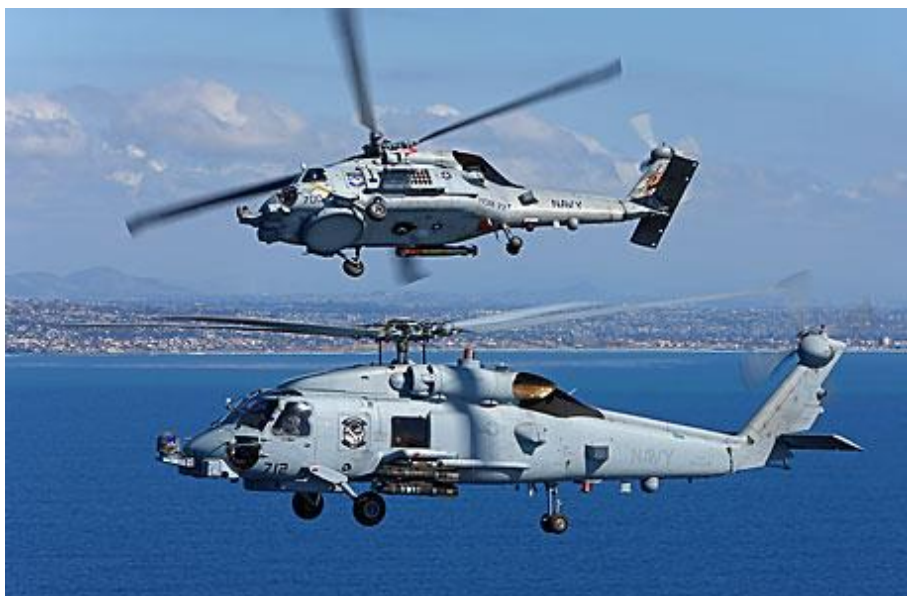
Figur 10: To MH-60R Seahawk maritime helikoptre. Det nærmeste med missiler for ASuW og det bakerste med en ASW-torpedo (kilde: Lockheed Martin)
