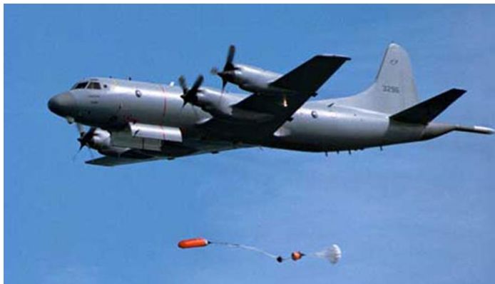
Figur 7: SKAD slippes fra et norsk P3 Orion (Kilde: Luftforsvaret)
