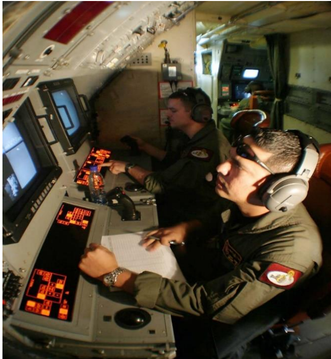
Figur 3: De to akustiske sensorstasjonene om bord i P3C. (Kilde: US Navy)
