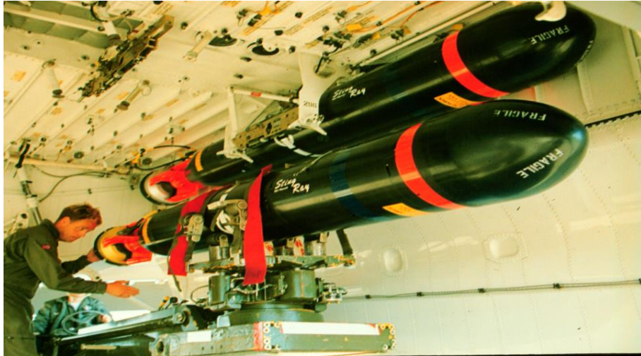
Figur 6: Bomberommet i P3 med 2 stk. Stingray torpedoer (Kilde: 333 skv Luftforsvaret)
